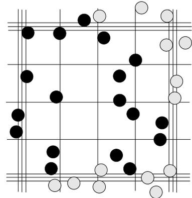
Mitgezählt werden die an 2 (!) Seiten, z.B. an der linken und oberen Maßlinie, an- oder aufliegenden Zellen (schwarz markiert). Dies gilt auch für die Art des eigentlichen Zählvorganges, der mäanderförmig erfolgen soll.
